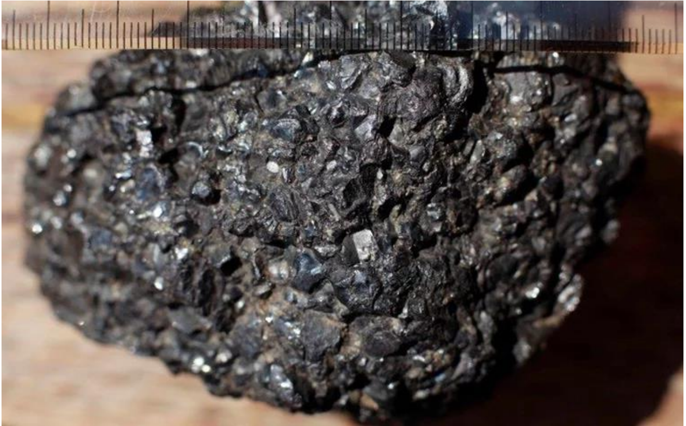
Photo 3. Minerai d'Ilménite (fer et titane de la Mine du Lac Allard, au nord de Havre-Saint-Pierre, Moyenne Côte-Nord. Observez l'éclat dit métallique et la forme hexagonale des cristaux.
