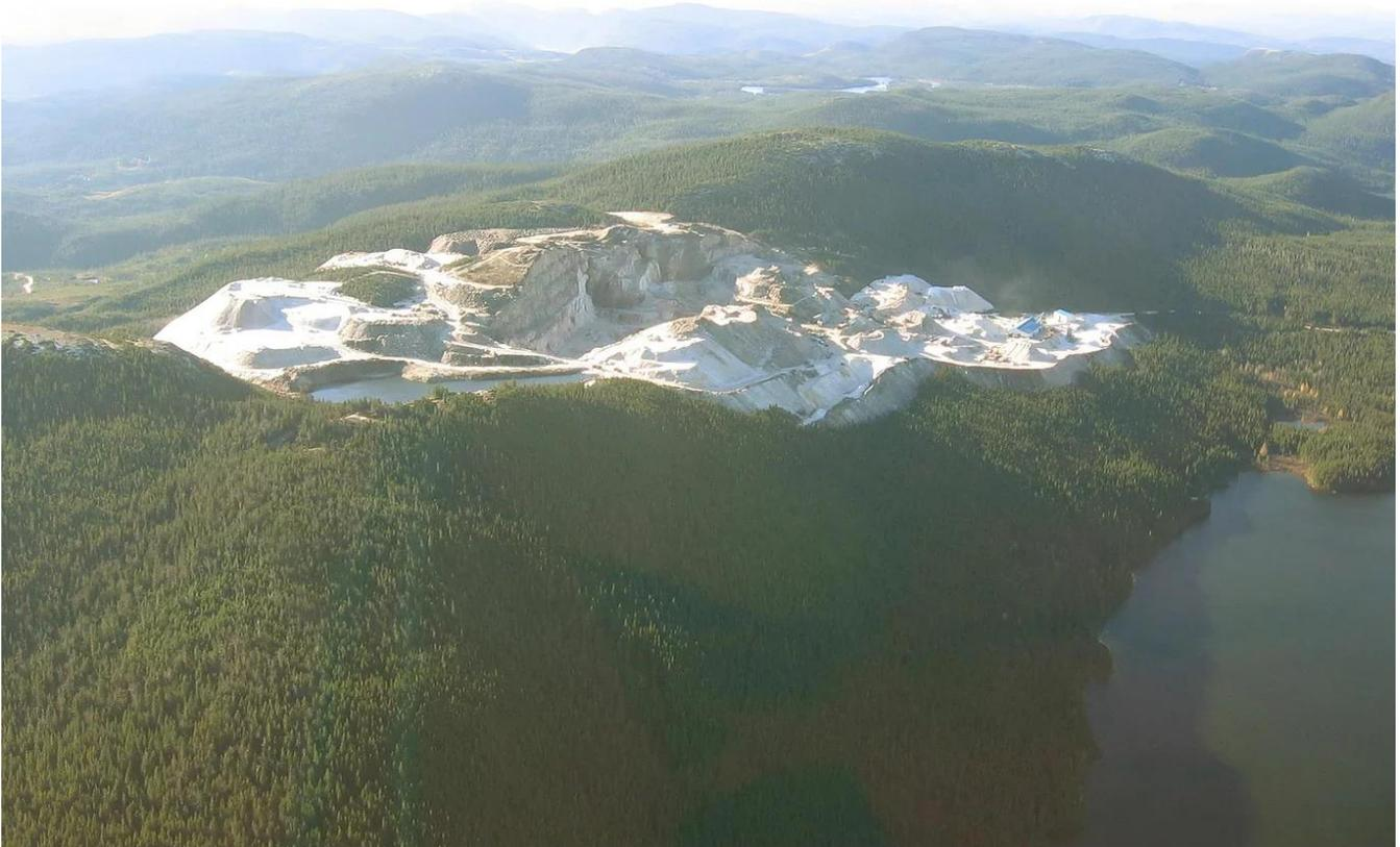
*Photo 4. La mine de Sitec Quartz, près du Petit Lac Malbaie. On aperçoit ici la cavité d'extraction et des piles de stockage de différentes qualités de silice.*
